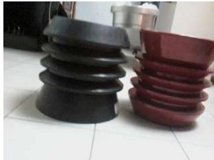
Los Tapones AluPlug™ Cementing son adecuados para ambientes de Altas Presiones /Altas Temperaturas en fluidos de perforación base agua y base aceite. El tapón de fondo (AluPlug™ Bottom Cementing) es suministrado con un disco de ruptura nominal de 750 psi, sin obstrucción alguna de su área de flujo luego de la ruptura.
